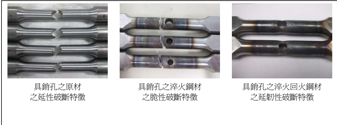
圖六 不同熱處理之具有銷孔之試片在拉伸試驗後之破斷特徵
