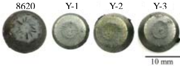
圖 6. 8620 及三種新配製合金鋼於拉伸試驗破斷後之巨觀斷面型態
