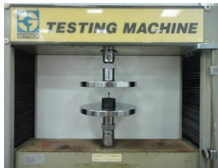
圖 3. 試驗機進行微衝壓情形
