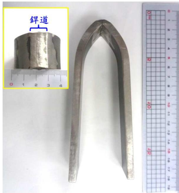
圖 4. 完軋狀態之 800H 熱軋板與 304 不銹鋼銲接處經 5T 彎曲試驗後試片之側視照片，與俯視方向之插圖比對可確認銲道並無明顯裂縫產生。
