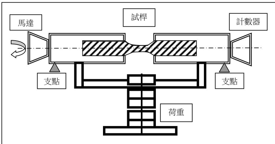
圖五 旋轉彎曲疲勞試驗試桿及荷重之示意圖
